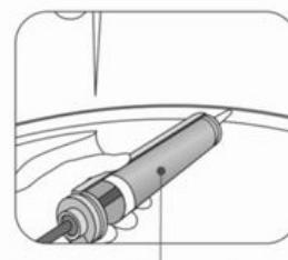
После проверки, убедившись, что все установлено верно, набейте уплотнительный материал в проемы между стенкой и крышей изделия и стеной, а также стеной и боксом и поддоном. Это поможет предотвратить течь воды и сквозняки.
