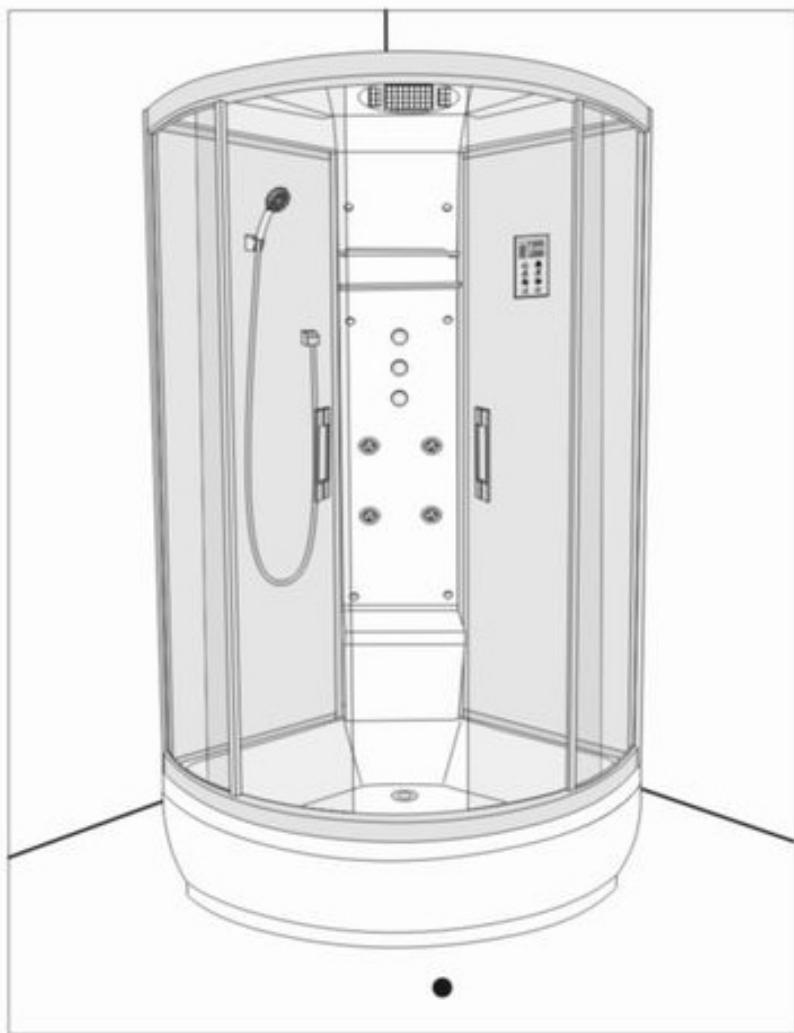
1. Электропитание для паровой кабины должно быть  $220V \pm 10\%$ ,  $50Hz$ . Питание должно подаваться через отдельную линию с отдельным выключателем и защитой. Должно быть обеспечено заземление. Перекрестная область секции энергетического провода должна как минимум составить  $4mm \times 2$ .
