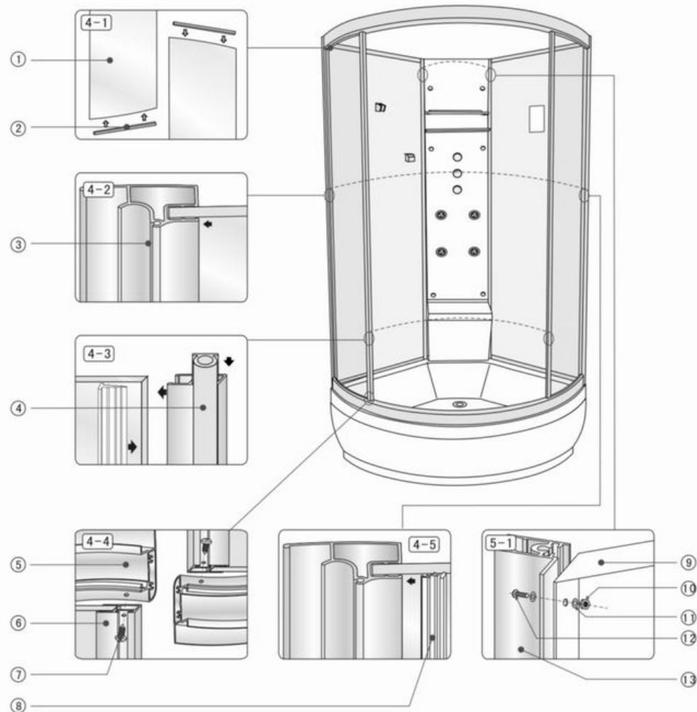
Перед установкой стеклянной двери не забывайте установить уплотнитель, для чего возможно использование резинового молотка для осуществления ударов по алюминиевой штанге и направляющему плотному совмещению штанги и стекла.
