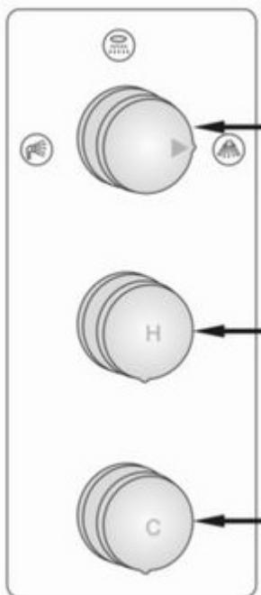
Вращением ручки , показанной справа, вы можете регулировать напор горячей воды. Вращение по часовой стрелке сокращает напор; вращением против часовой стрелки напор усиливается.
