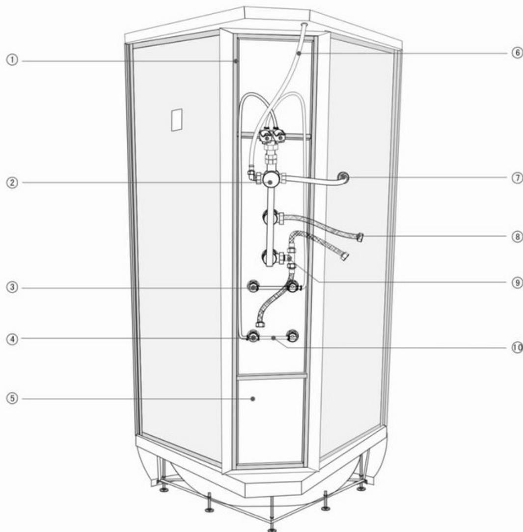
1. 3.04.0204802300 Рама профиля из нержавеющей стали для функциональной панели
