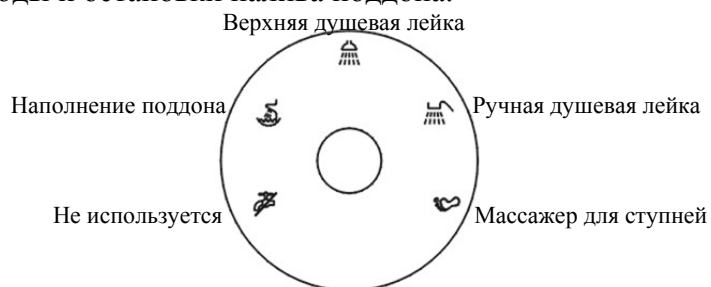
Рис. 2 Функциональные положения вентиля налива (распределения воды)
