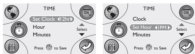
Pulse la zona izquierda o derecha del teclado para elegir entre el formato de 12 horas o 24 horas. Después pulse la zona inferior para acceder a la selección de la hora.
