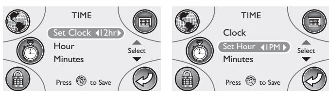
Воздействовать на левую или правую зону кнопочной панели для выбора отображаемого формата 12 часов или 24 часа. Затем нажать на нижнюю зону для доступа к выбору времени.
