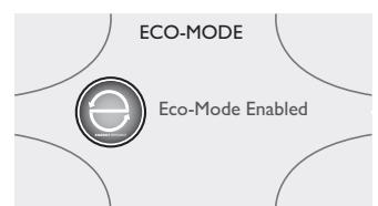
При выборе использования данного режима, нажать центральную кнопку на кнопочной панели. На дисплее подтверждается ваш выбор, который будет отображен на несколько секунд, а затем вновь возвращается в подменю Heating (Нагрев).
