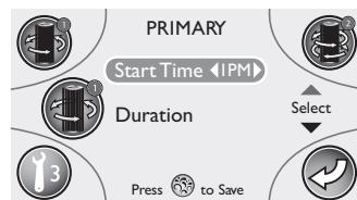
■ Воздействовать на левую или правую зону кнопочной панели для выбора времени, в которое рециркуляционный насос начинает работу.
