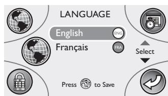
■ Использовать кнопочную панель для перехода с английского на французский путем воздействия на верхнюю или нижнюю зону.
