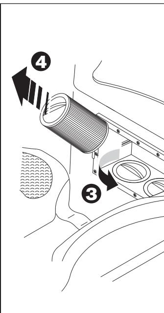
► Разделить складки фильтра и очистить струей водой под давлением.
