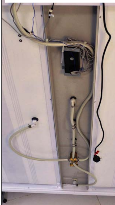
Рис. 63. Подключение шлангов подвода воды
