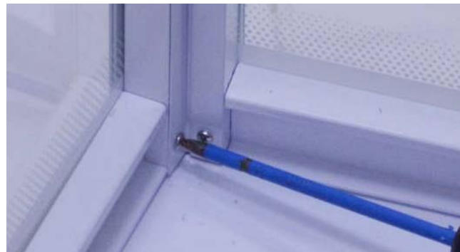
Рис. 45. Соединение профиля №1 со стойкой снизу
