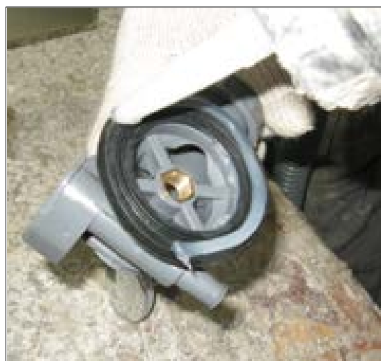
Рисунок 11. Установите прокладку и нанесите герметик в ее канавку
