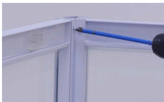
Рис. 44. Соединение профиля №1 со стойкой сверху
