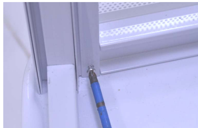
Рис. 43. Соединение профиля бокового стекла со стойкой снизу
