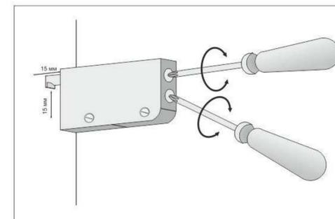
Регулировка по глубине осуществляется вращением верхнего регулировочного винта.
