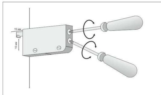
Регулювання по глибині здійснюється обертанням верхнього регулювального гвинта.
